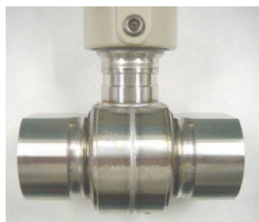
Rysunek 31 — Spawany korpus pomiarowy
